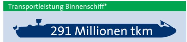
\*Im Güterverkehr wird die Transportleistung eines Verkehrsträgers in Tonnenkilometer (tkm) gezählt. Die transportierten Massen (t) werden mit der dabei zurückgelegten Wegstrecke (km) multipliziert.
